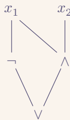
Fig. 1. Un circuit calculant l'ensemble \{00, 01, 11\}
